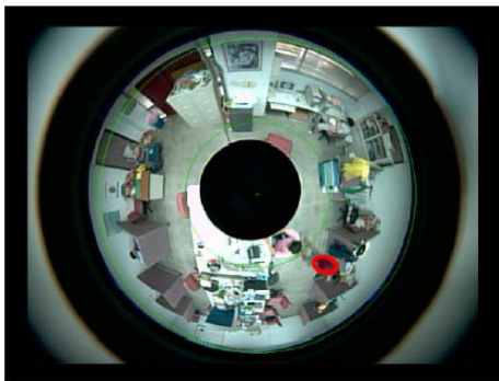
Figura 1.4. Resultado del seguimiento omnidireccional de una persona utilizando el algoritmo CamShift [WaM+ 2006].
